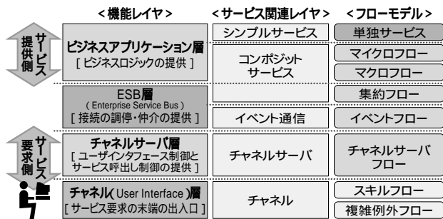
図2. エンタープライズシステムのレイヤとフロー
