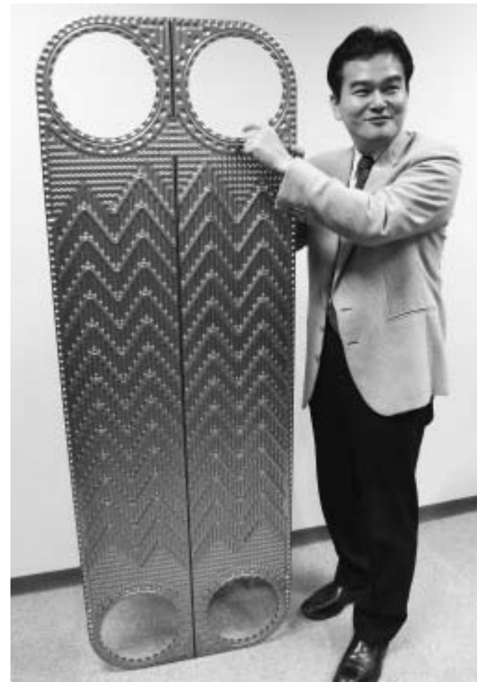
効率的に蒸気を冷やして液体に戻すチタン製の板状プレート
