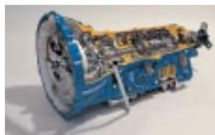
トヨタセルシオ向 FR5速オートマチックトランスミッション
