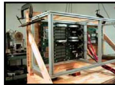
宇宙線の照射によるエラー発生率を測定する実験装置 [4]
